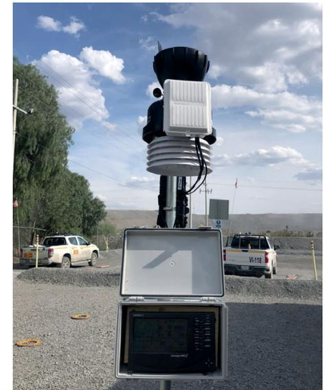
*Les stations de surveillance de la poussière sont dotées de plusieurs outils qui mesurent la poussière de façon continue sur une période de plus de 12 heures, enregistrent le passage de véhicules et les conditions météorologiques en temps réel.*
